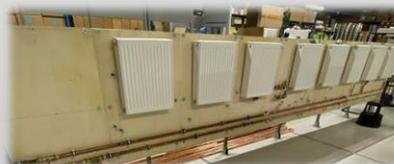
PROXISERVE dispose de banc de formation pour leurs techniciens avec tous les modèles de chaudières et tous les types de raccordement des radiateurs envisageables.
